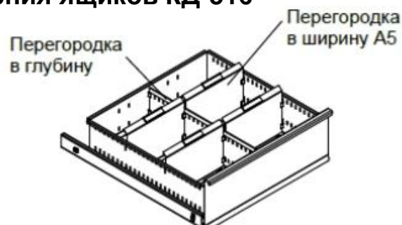
1xКД-516/536 Перегородка в глубину +4xКД-516/536 Перегородка в ширину А5 (две ячейки с шириной 229 мм)
